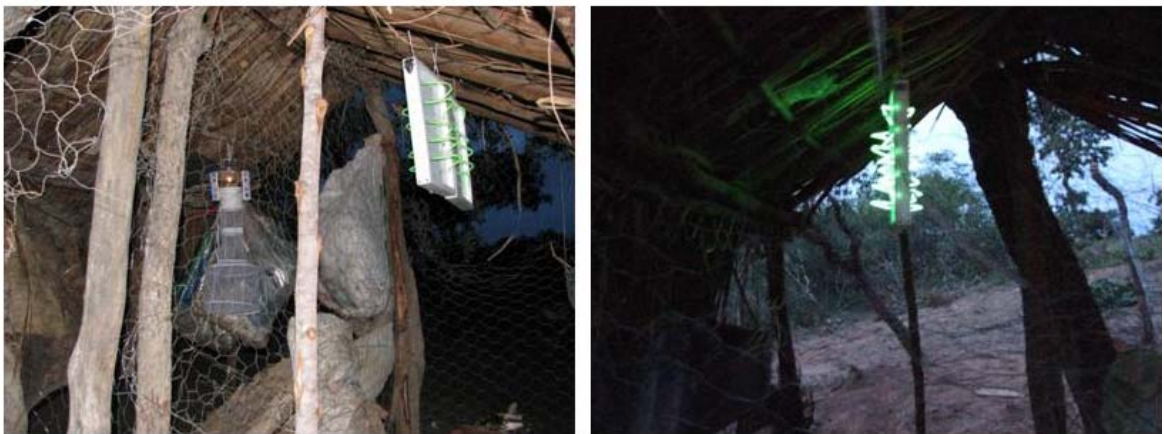
Figura 10- Testes realizados em Chapada Gaúcha (MG) usando dois protótipos da armadilha Leishtrap (P3) no interior de galinheiros.
