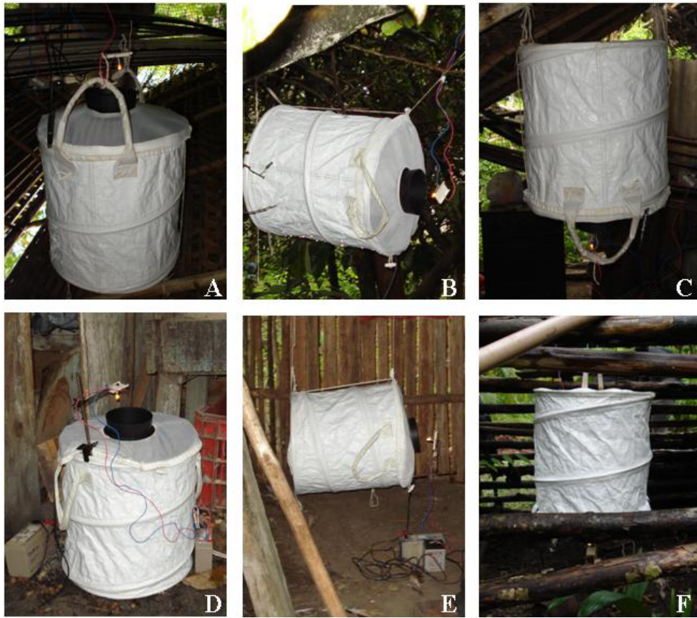
Figura 6- Disposição da abertura de sucção a armadilha BG-Sentinela com luz incandescente na posição normal a 1,5 m do solo ( A ), BGS de lado a 1,5m do solo ( B ), BGS invertida a 1,5 m do solo ( C ), BGS normal a 40cm do solo ( D ), BGS de lado a 40cm do solo ( E ), BGS a 40cm do solo ( F ).
