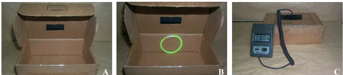
Figura 6- Procedimentos para medida da intensidade luminosa das pulseiras de Neon: A- caixa perfurada na tampa; B- pulseira de neon (= luz química) no interior da caixa de papelão (10,5 x 7,0 x 3,5 cm); C- Luxômetro para medida de intensidade luminosa.
