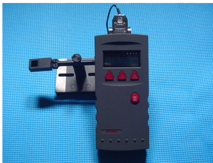
FIGURA 13. UNIDADE DE LEITURA DE POTÊNCIA LUMINOSA.
