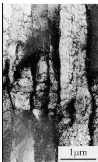
FIGURA 2.16 - Processo de nucleação de uma banda de cisalhamento a partir de pequenas microbandas. Fonte: CIZEK (2002), FIG. 1, p 215
