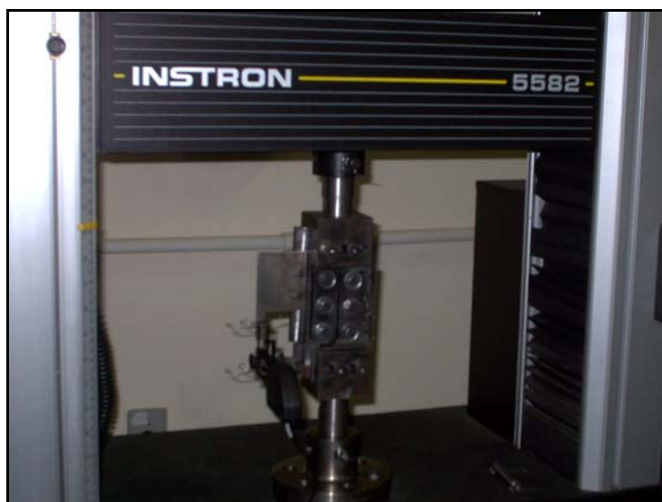
FIGURA 3.14 – Garra de cisalhamento montada na máquina de ensaios INSTRON 5582.
