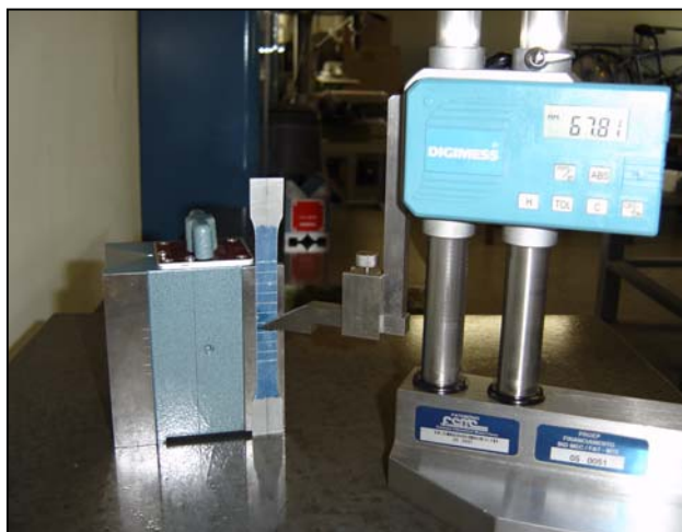
FIGURA 3.4 – Traçagem do corpo de prova para ensaio de tração.
