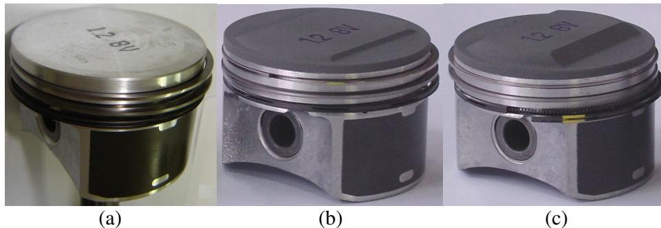
Figura 3.1 - Pistões para razão volumétrica de compressão de (a) 11:1, (b) 12,5:1, (c) 15:1.
