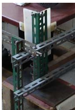
Figura 3.4 – Detalhes da guia utilizada para garantir excitação apenas no eixo z do set-up experimental.
