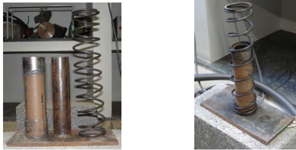
Figura 3.2 – Detalhes de montagem das molas utilizadas no set-up experimental.
