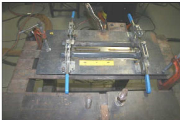
FIGURA 3.2 - Sistema utilizado para a soldagem robotizada.
