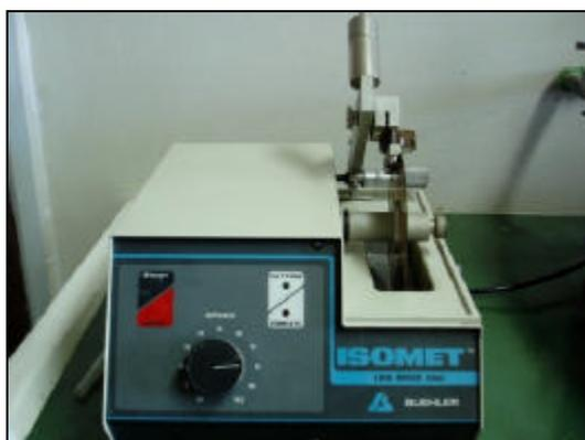
FIGURA 4.8 -Equipamento para corte ISOMET.
