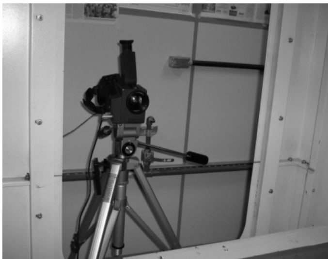
Figura 4.7 – Câmara termográfica Agema.
