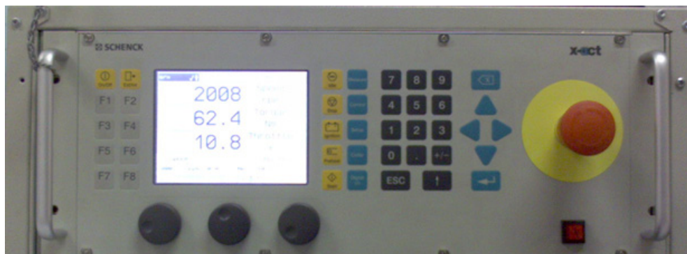
Figura 4.25 – Módulo de Controle do Dinamômetro
