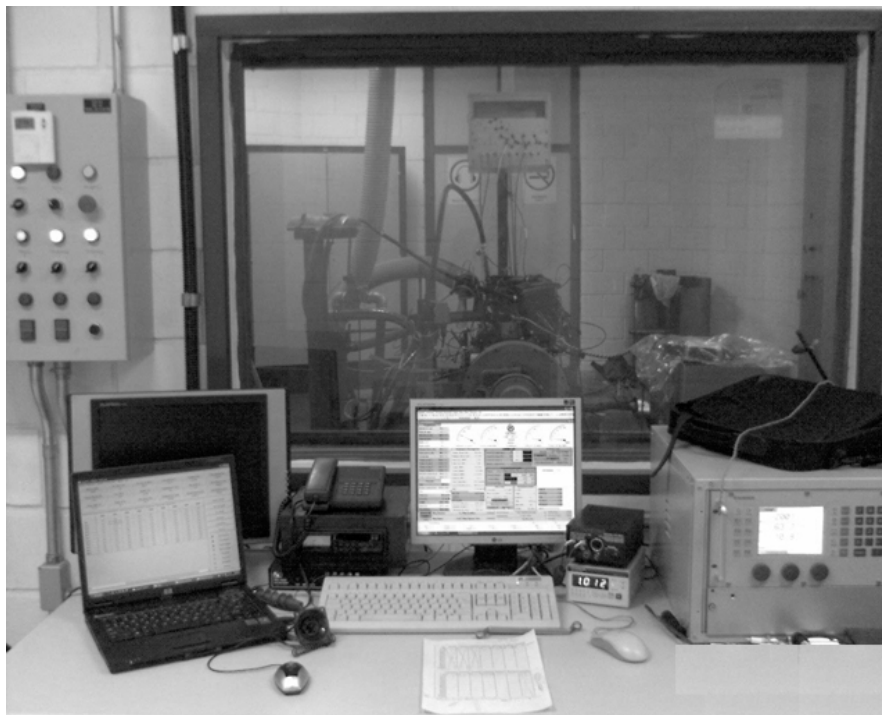
Figura 4.27 – Vista da Sala Dinamométrica da Mesa de Controle
