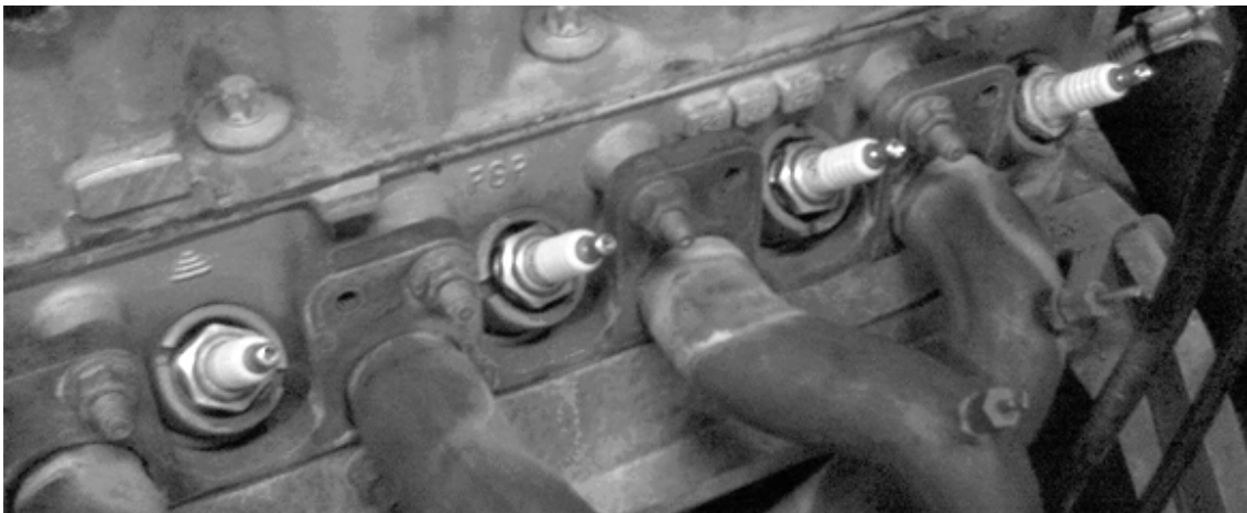
Figura 4.21 – Pré-Câmaras de Velas Centralizadas montadas no Cabeçote
