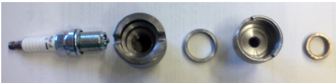
Figura 4.18 – Conjunto do Sistema de Pré-câmara, mostrando da esquerda para a direita a Vela de Ignição, o Corpo Superior, o Anel Extensor de Aço, o Corpo Inferior e o Anel de Vedação de Bronze.
