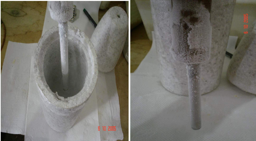
(a) (b) FIGURA 6: O bastão sendo resfriado em Nitrogênio Líquido.
