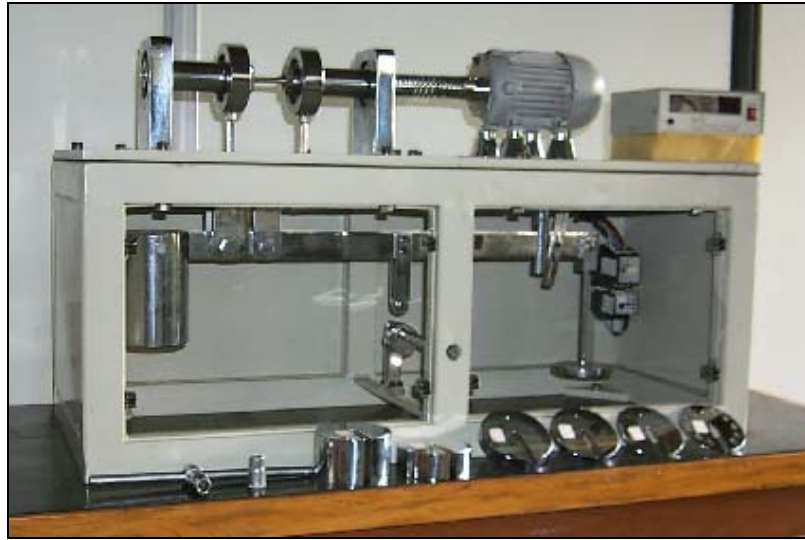
Figura 4.09 – Foto da máquina de fadiga flexo-rotativa desenvolvida no CDTN.
