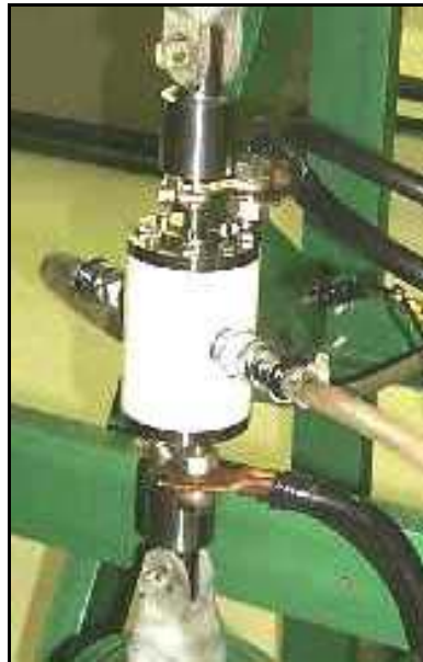
Figura 4.15 - Montagem do corpo-de-prova.
