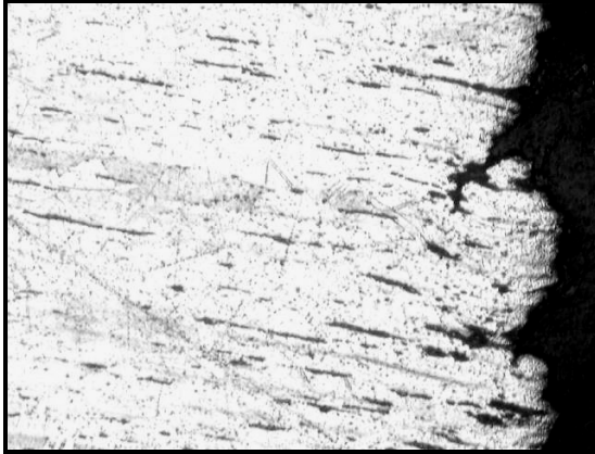
Figura 5.13 – Microestrutura e região de fratura do corpo-de-prova n° 33 (200X) fadigado mecanicamente com uma tensão de 311 MPa durante 215.000 ciclos.
