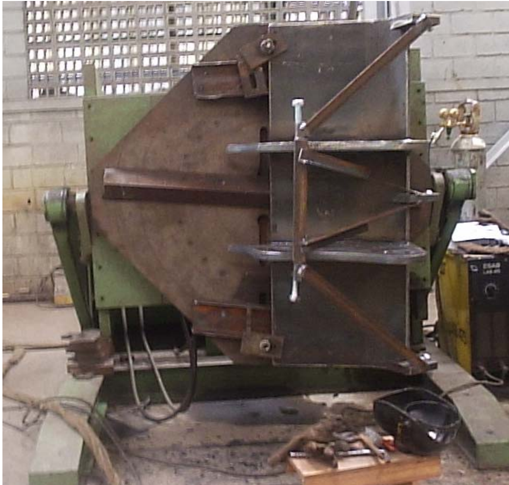
FIGURA 3.22: viga com fixação móvel no posicionador para soldagem (TBM - cortesia)
