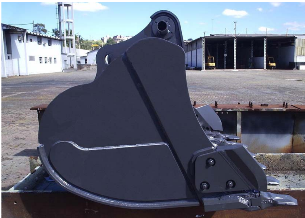
FIGURA 5.20: Montagem da caçamba finalizada. (Vista Lateral)
