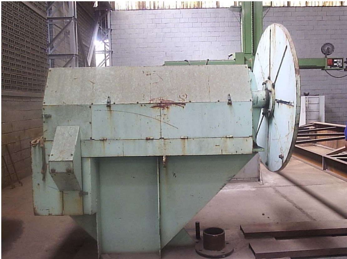
FIGURA 3.20: posicionador com 1 grau de liberdade (rotação da placa na vertical) (TBM - cortesia)
