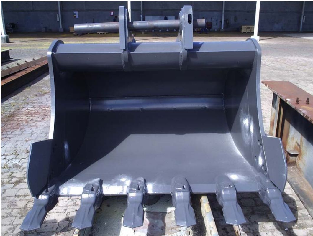
FIGURA 5.19: Montagem da caçamba finalizada. (Vista Frontal)
