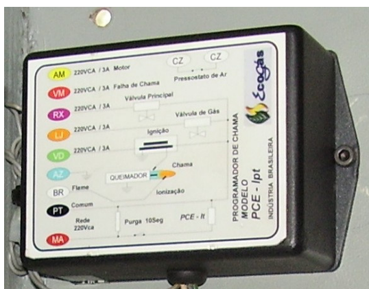
FIGURA 5.17 - Central de Controle de Combustão
