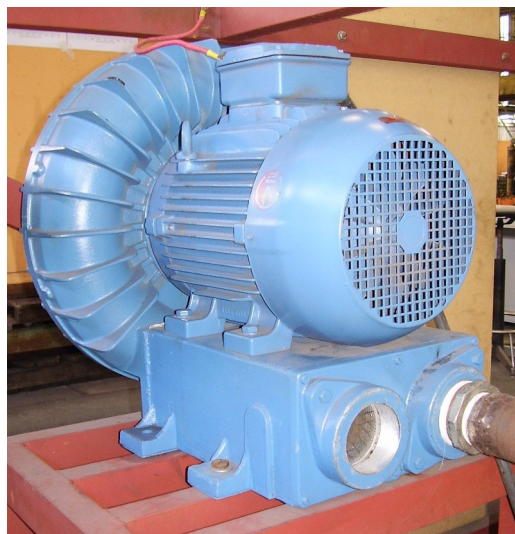
FIGURA 5.10 - Compressor Radial CV-751
