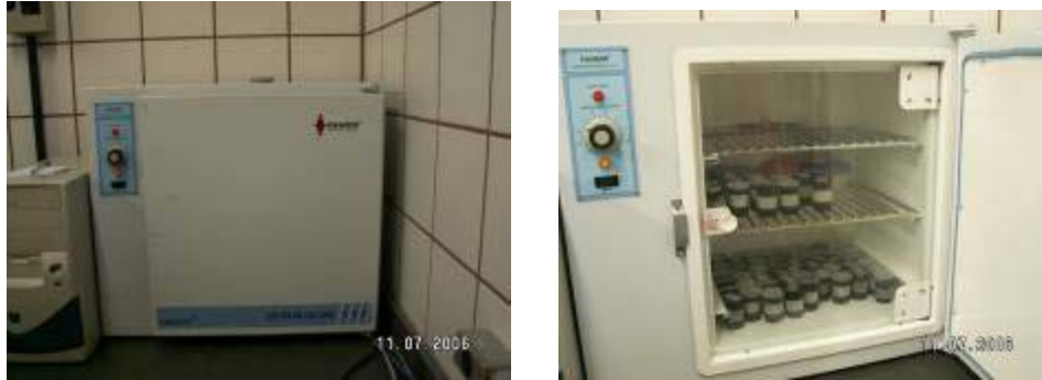
Figura 4.5: Estufa com os recipientes contendo os corpos de prova em água.
