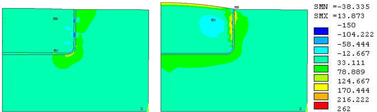
Figura 5.11 - Expansão Higroscópica da resina TPH – dados retirados do experimento realizado.
