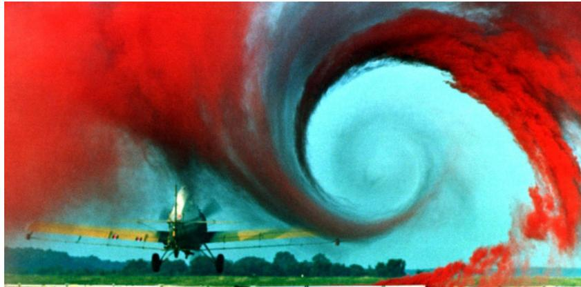
**Figura 2-6 Vórtice de ponta de asa em uma aeronave agrícola no momento da liberação do agrotóxico.**
