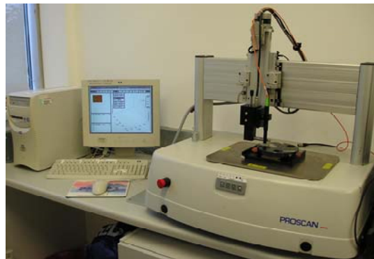
Figura 3.10: Perfilômetro Óptico para medição de rugosidade superficial
