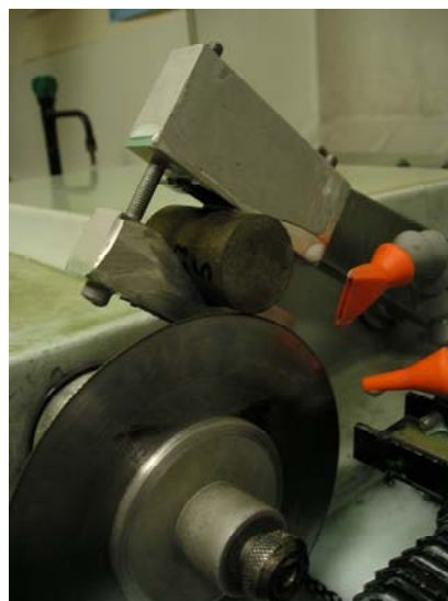
Figura 3.17: Corte de precisão para padronização dos corpos de prova
