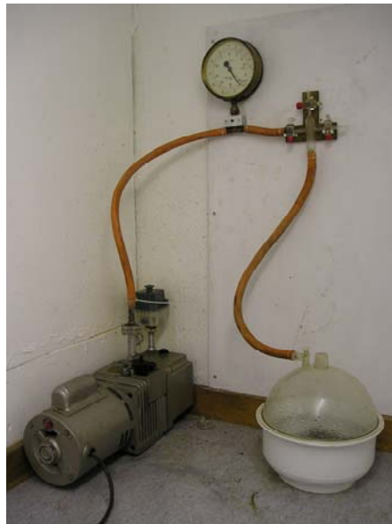
Figura 3.1: Montagem de sistema para saturação de água nas amostras
