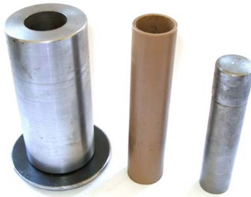
Figura 3.14: Matriz, molde polimérico e punção de prensagem.
