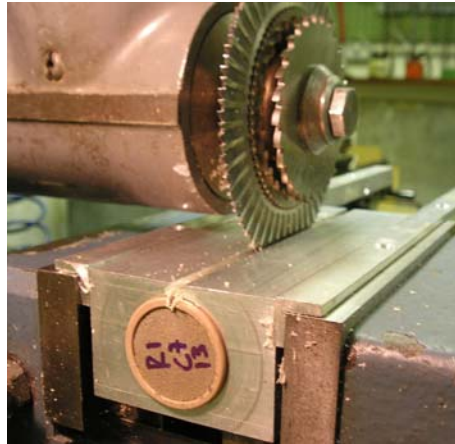
Figura 3.16: Desmoldagem dos corpos de prova
