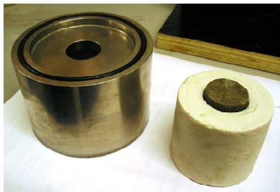
Figura 3.4: Sistema de vedação de gás e acoplamento da amostra no permeômetro.
