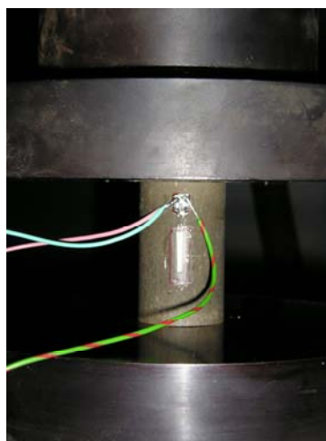
Figura 3.6: Célula de carga e fixação dos Strain Gauges.
