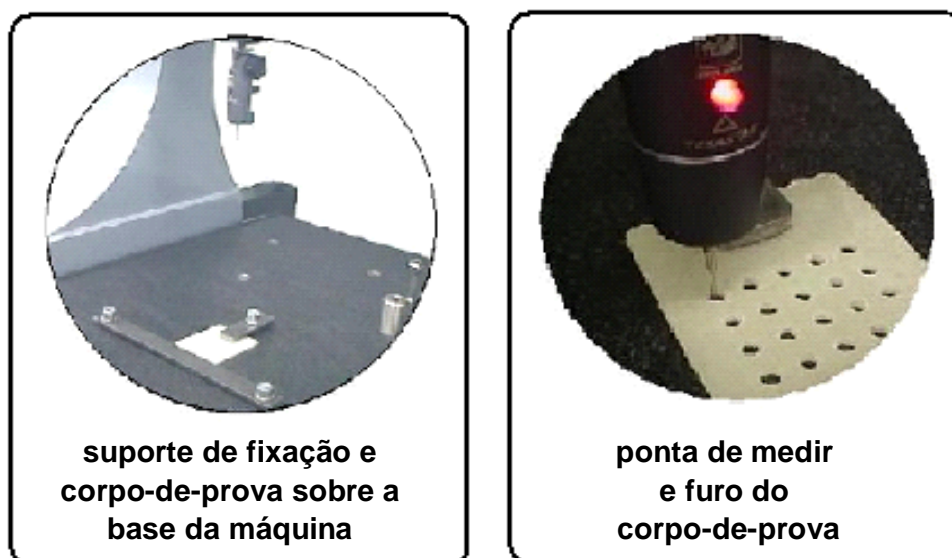
Figura 4.19 - Medição do diâmetro e da circularidade do furo.
