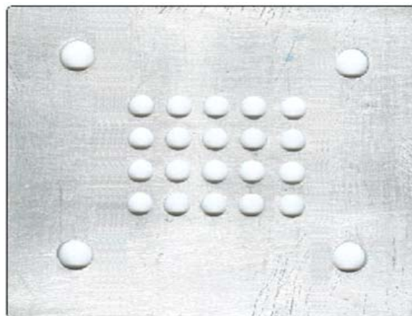
Figura 4.11 - Placa de alumínio usada como suporte de fixação sobre o dinamômetro.
