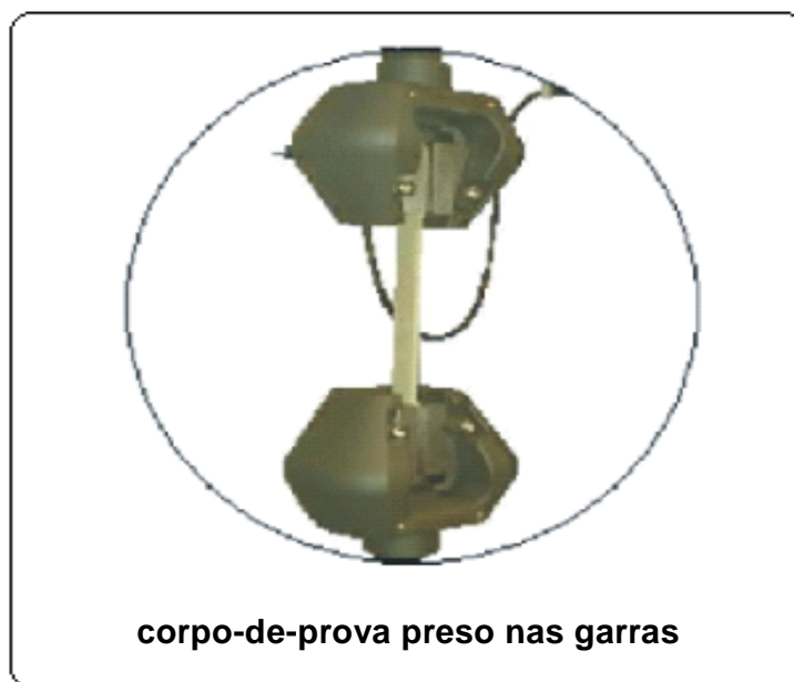
Figura 4.9 - Ensaio de resistência mecânica à tração realizado no compósito.
