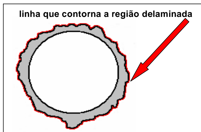
Figura II.2 - Representação esquemática da imagem da área do furo, da área delaminada e da linha que demarca a região com delaminação.
