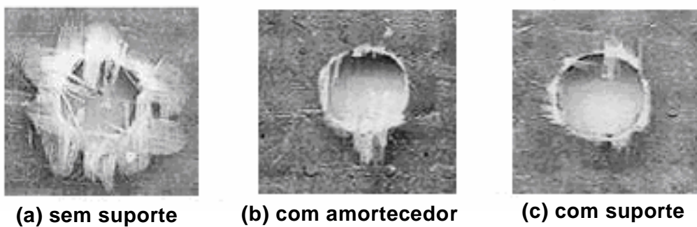
Figura 3.67 - Fotografia dos furos: (a) furo com delaminação gerado sem utilizar suporte, (b) furo com pouca delaminação, utilizando-se amortecedor e (c) furo com pouca delaminação, utilizando-se suporte, conforme (Capello, 2004).
