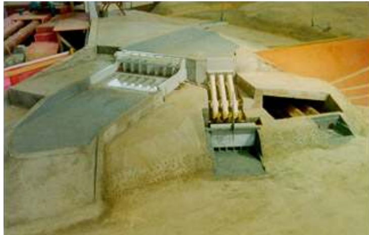
FIGURA 2.7 – Modelo em escala reduzida de usina hidroelétrica. FONTE – MAESA, 2002. (Adaptado)
