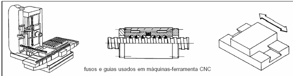
FIGURA 2.53 – Esquema de fusos e guias usados em máquinas CNCs FONTE: www.mundocnc.com.br, 2006 (adaptado)
