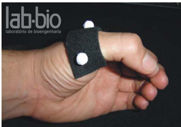
Figura 3.3 - Detalhe dos marcadores passivos reflexivos
