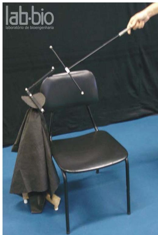
Figura 3.2 - Processo de calibração do sistema de análise do movimento Qualisys
