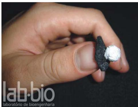
Figura 3.13 - Marcador Passivo Reflexivo 10 (MPR10) *in situ*.
