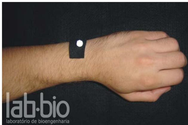
Figura 3.8 - Marcador Passivo Reflexivo 2 *in situ* (MPR2).
