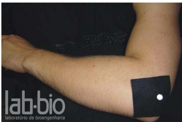
Figura 3.7 - Marcador Passivo Reflexivo 1 *in situ* (MPR1).
