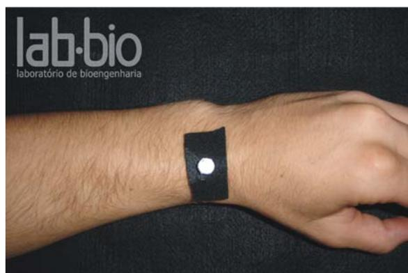
Figura 3.9 - Marcador Passivo Reflexivo 3 *in situ* (MPR3).
