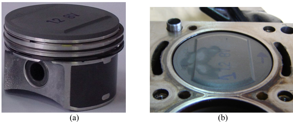
Figura 3.7: Pistão para a razão de compressão de 12,5:1 (a) fora do motor e (b) instalado
