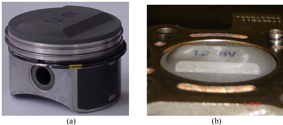
Figura 3.8: Pistão para a razão de compressão de 15:1 (a) fora do motor e (b) instalado
