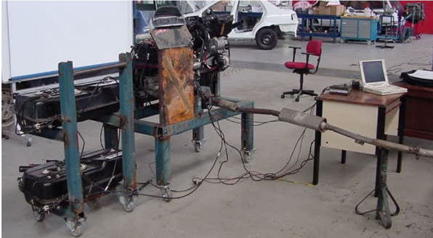
Figura 3.1: Motor na bancada para testes com a UCE IAW1G7 e o software CAT.
