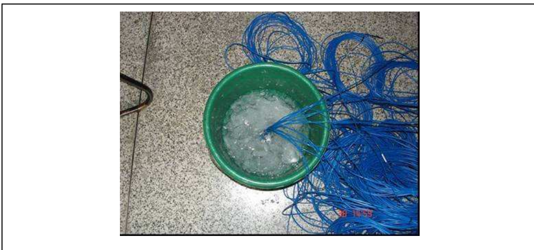
FIGURA C.2 - Sistema de calibração. A calibração do conjunto de termopares
