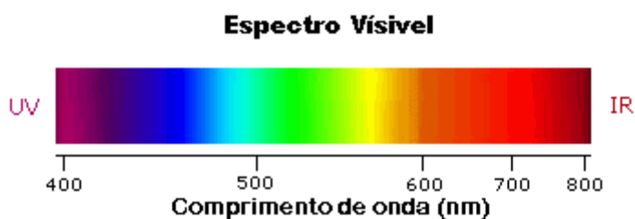
Figura 24 – Espectro de luz utilizado por um espectrômetro de ultravioleta e luz visível.
