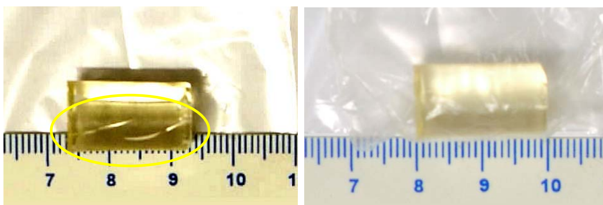
Figura 54 – Fotos da trinca e do xerogel regenerado da amostra 90F1, respectivamente. Em detalhe, as indicações das trincas ocasionadas em 10 segundos de exposição ao ar.
