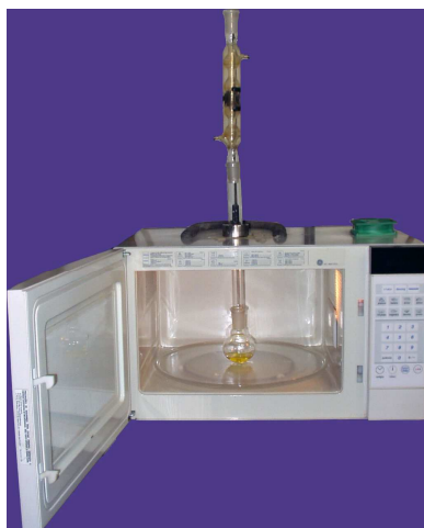
Figura 12 - Adaptações realizadas no forno de microondas doméstico.
