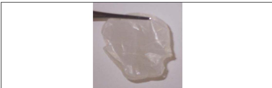
Figura 53 – Filme do eletrólito TPUPPP25Li obtido por “casting”.
