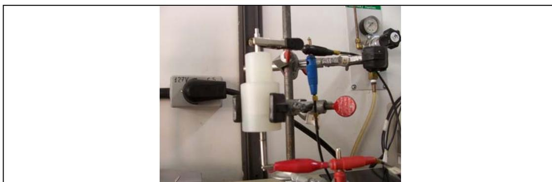
Figura 10 – Célula eletroquímica de teflon para medida dos capacitores.
