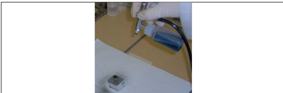
Figura 9 – Deposição das camadas por “spray casting”.
