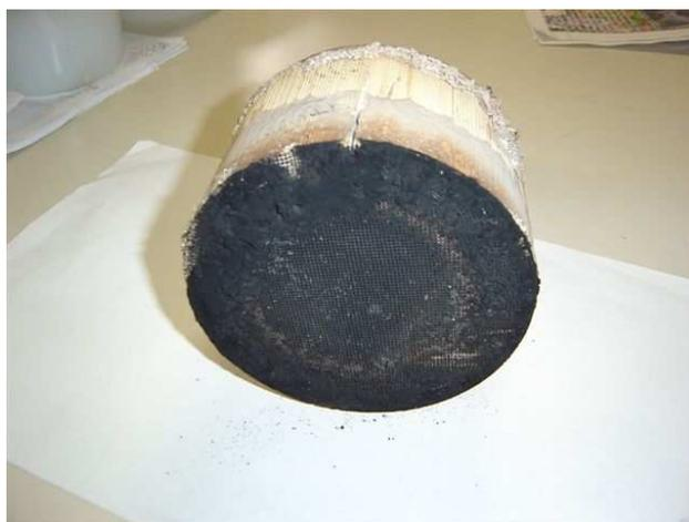
Figura 45 – Imagem do catalisador usado totalmente contaminado com fuligem
