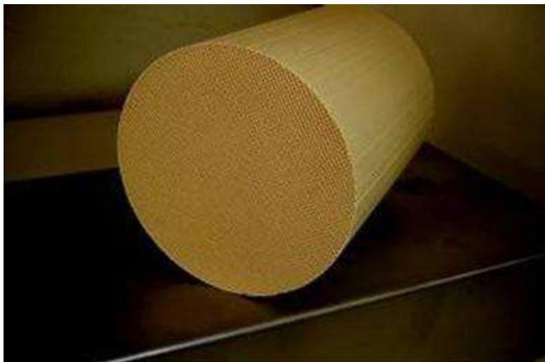
Figura 54 – Imagem do material cerâmico do catalisador novo sem a carcaça metálica.
