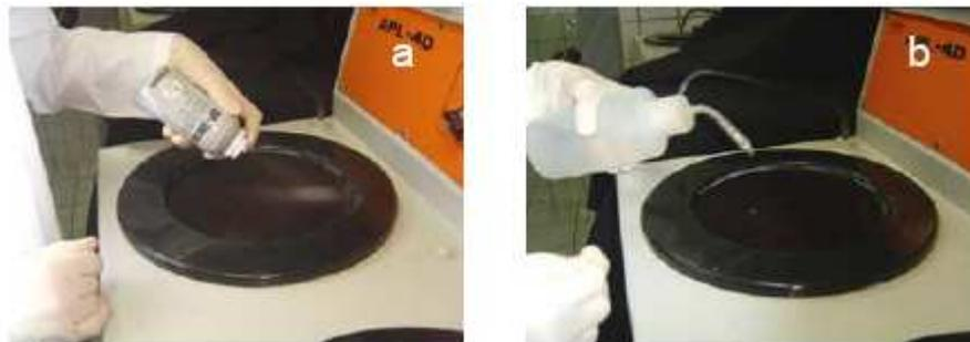
Figura 83 – Imagem da politriz. Em “a” adição de abrasivo e em “b” adição de álcool lubrificante [107].
