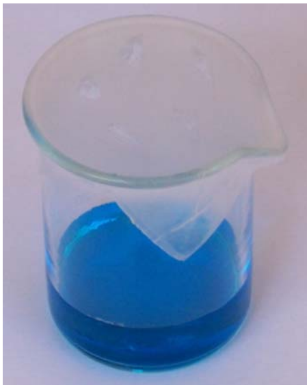
Figura 45. Sistema de cristalização por evaporação lenta.
