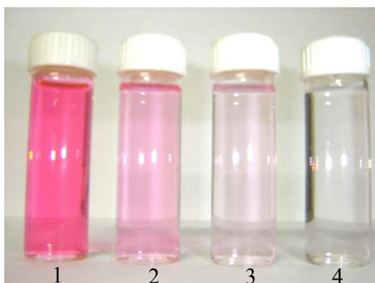
Figura 3.14 – 1) Solução do corante Eritrosina 2) Solução do Eritrosina após 30 min de reação com NaClO 0,805 mol L<sup>-1</sup>. 3) Solução da Eritrosina após 30 min de reação com UV/H<sub>2</sub>O<sub>2</sub> 0,200 mol L<sup>-1</sup> 4) Solução da Eritrosina após 20 min de reação com O<sub>3</sub>.
