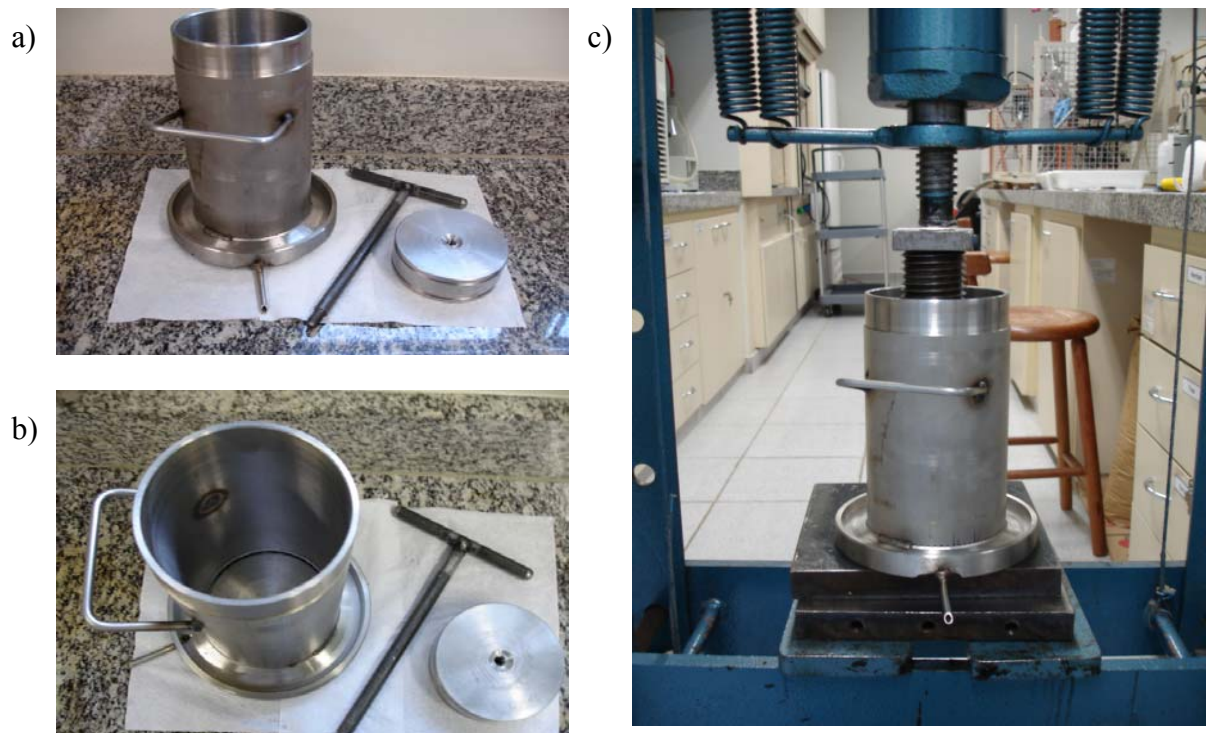
Figura 3.4: Esmagador de sementes utilizado nos experimentos: (a) Vista frontal; (b) Vista superior e (c) Montado na prensa para extração do óleo
