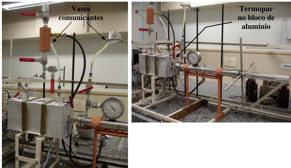
Figura 3.2: Vista geral do reator com volume variável utilizado na síntese supercrítica de biodiesel e detalhe da conexão entre os equipamentos
