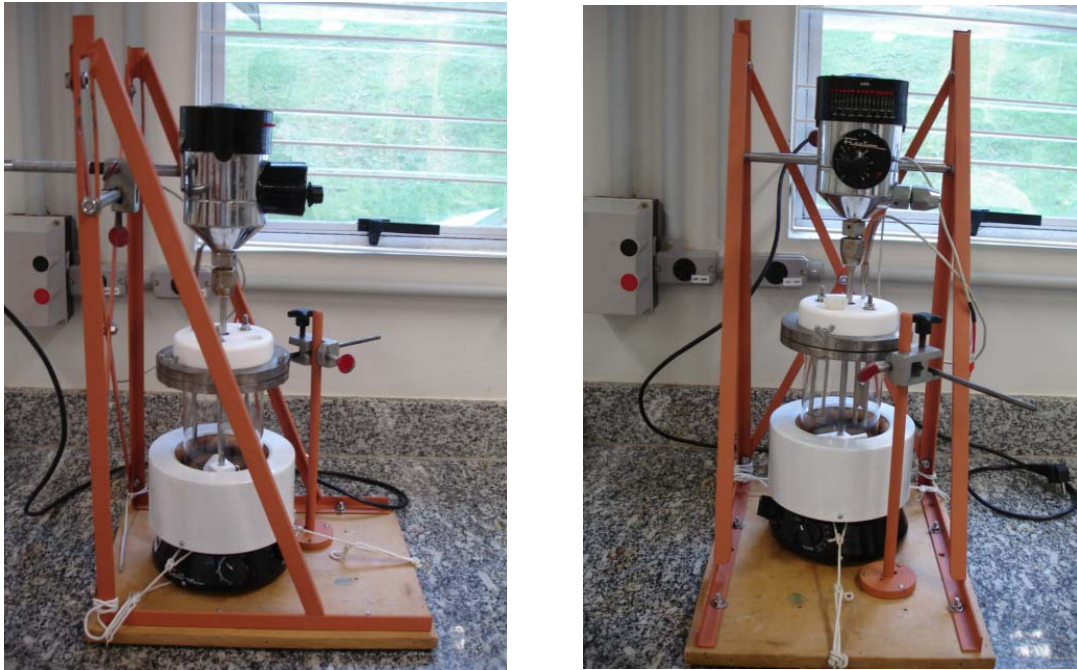
Figura 3.1: Vistas lateral e frontal da montagem utilizada para síntese de biodiesel por via catalítica
