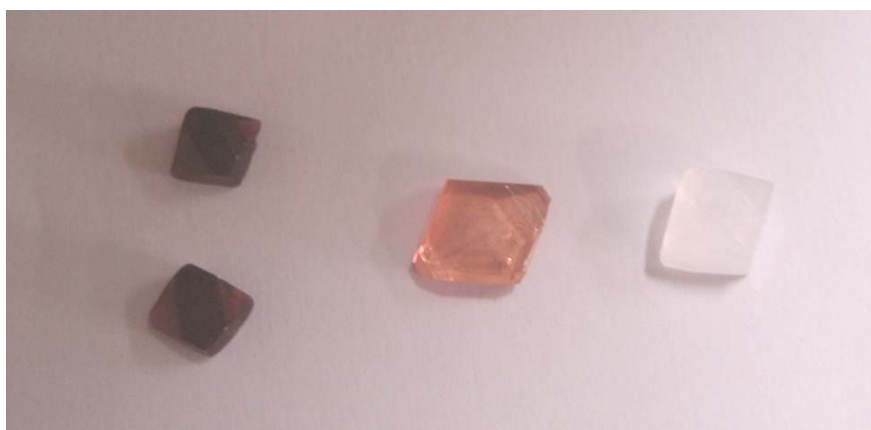
Figura 3 - À esquerda, cristais de \text{CoK}_2(\text{SO}_4)_2 \cdot 6\text{H}_2\text{O} , solução sólida \text{Zn}_{(1-x)}\text{Co}_{(x)}\text{K}_2(\text{SO}_4)_2 \cdot 6\text{H}_2\text{O} ao centro, e \text{ZnK}_2(\text{SO}_4)_2 \cdot 6\text{H}_2\text{O} à direita.
