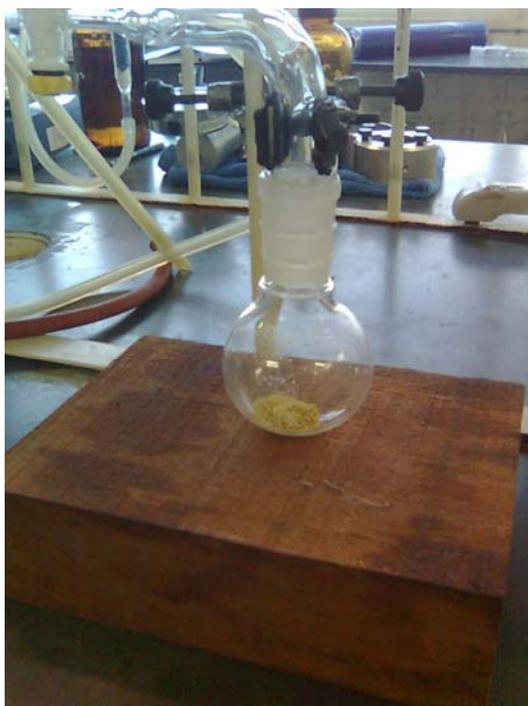
**Figura 17.** Secagem a vácuo do composto PS, obtido da reação do  $\text{Na}_2\text{S}\cdot 9\text{H}_2\text{O}$  com o CA comercial.
