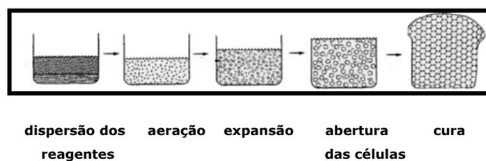
**Figura 11** - Etapas de formação de espumas flexíveis de poliuretano.
