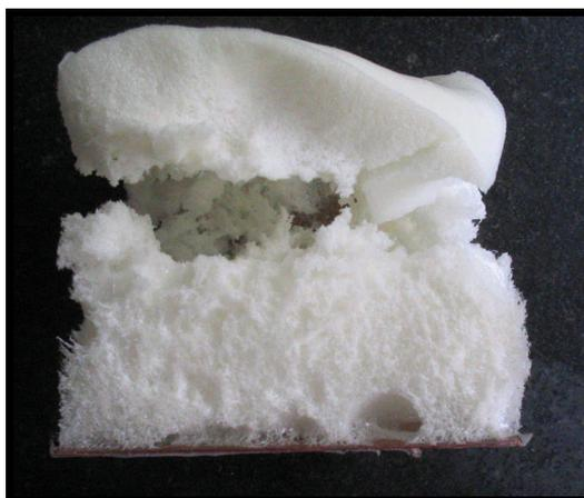
**Figura 61** - Espuma com rachadura lateral após rápida expansão.
