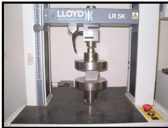
**Figura 15** - *Aparelho Lloyd utilizado nos testes de compressão.*
