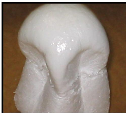
**Figura 60** - Encolhimento provocado pelo excesso de polimerização.
