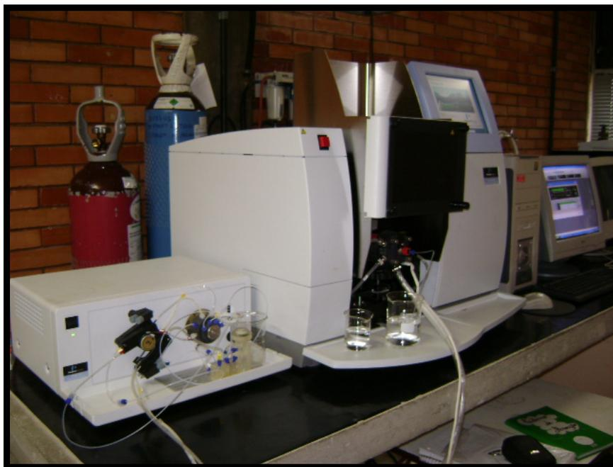
**Figura 7** – Espectrômetro de Absorção Atômica com geração de hidretos
