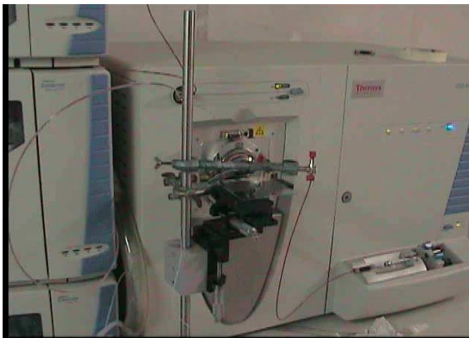
**Figura 3.5 - Visão geral do espectrômetro de massas e da fonte EASI montada na sua entrada.**
