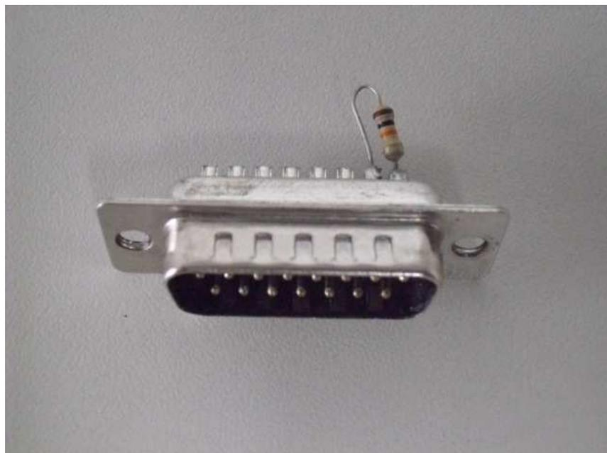
**Figura 3.4 - Plugue utilizado para permitir o funcionamento do espectrômetro de massas sem a presença da fonte ESI.**
