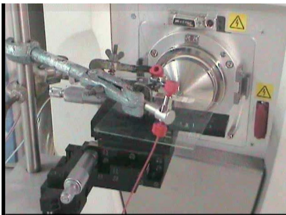
**Figura 3.6 - Detalhe da entrada do espectrômetro de massas e da fonte EASI.**
