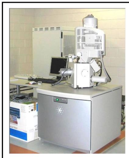
**FIGURA 2.7** - Imagem do microscópio eletrônico de varredura Quanta 200 da FEI® [6].
