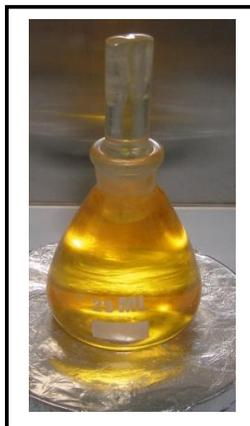
**FIGURA 2.5** - Modelo de picnômetro utilizado na realização das medidas de densidade.
