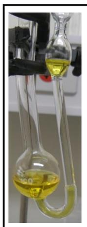
**FIGURA 2.6** - Viscosímetro de Ostwald utilizado na medição do tempo gasto para o escoamento de líquido pelo tubo capilar.
