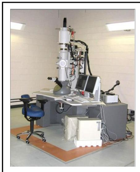
**FIGURA 2.8** - Imagem do microscópio eletrônico de transmissão Tecnai G2-20 da FEI<sup>®</sup> [6].
