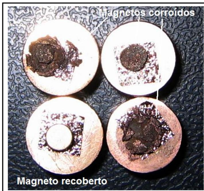
**FIGURA 4.7** - Imagem dos magnetos utilizados nos ensaios anticorrosivos empregando ácido láctico (1% m/v).
