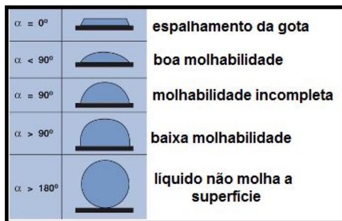
**FIGURA 2.16** - Relação do ângulo de contato com o grau de molhabilidade.
