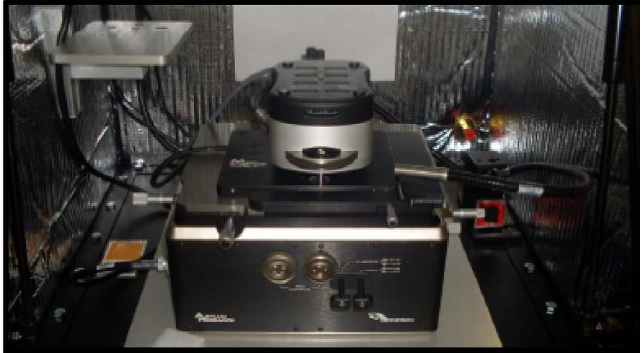
**FIGURA 2.9** - Microscópio de varredura por sonda MFP3D da Asylum Research®.
