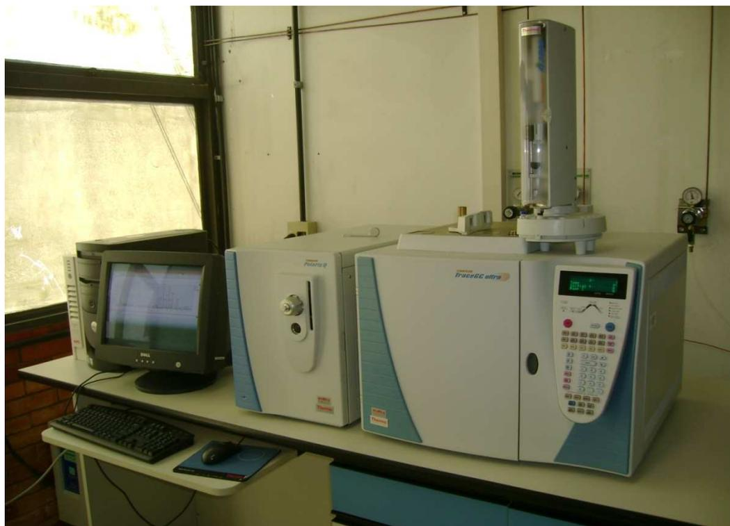
**Figura 3.3** – Sistema GC/MS (Thermo-Finnigan com detector de espectrometria de massas).
