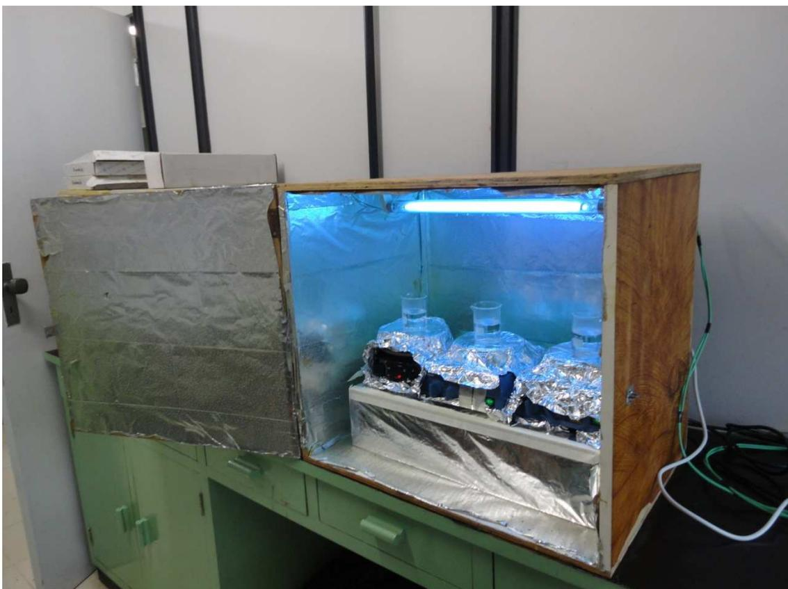
**Figura 4.2** - Câmara de radiação UV contendo placas de agitação e lâmpada UV.
