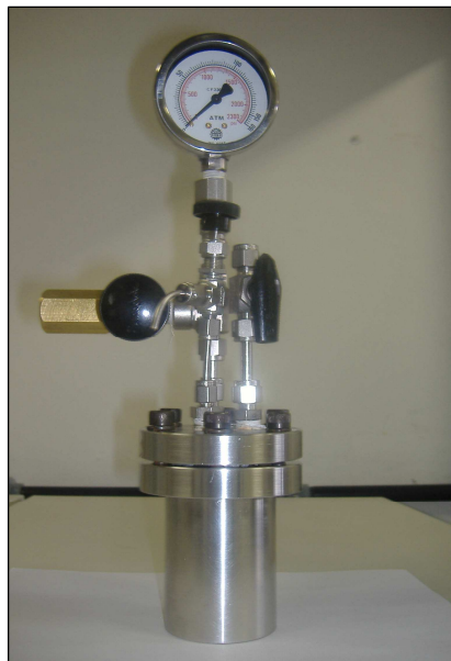
Figura 2.2. Foto ilustrativa da autoclave utilizada nos testes catalíticos realizados a pressões superiores a 1 atm.
