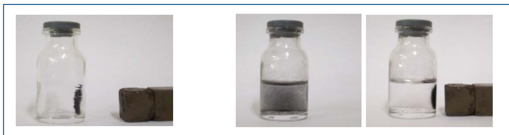
Figura 1.9. Separação magnética de um catalisador suportado em partículas de Ferro recoberto com carvão
