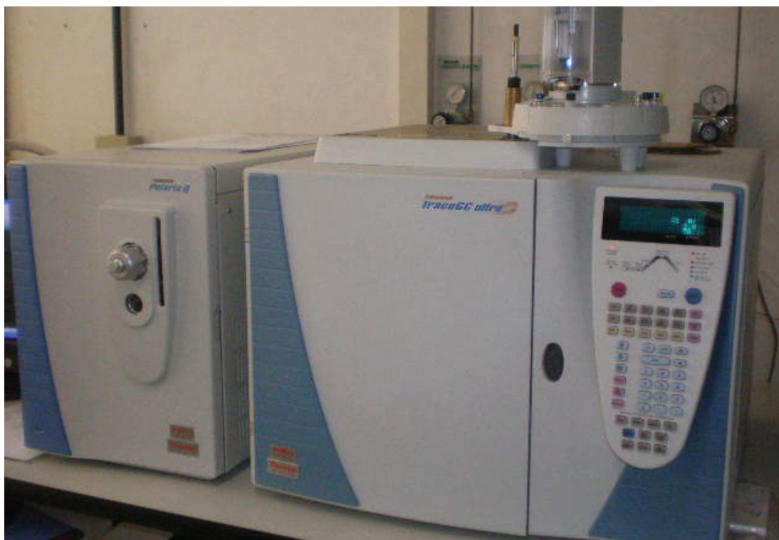
Figura 12: Sistema de GC/MS (Thermo-Finnigan com detector de espectrometria de massa) contendo um dispositivo SPME inserido no injetor.
