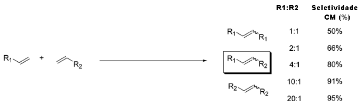
Figura 12: Influência da proporção das olefinas utilizadas na seletividade do produto de metátese cruzada [31].
