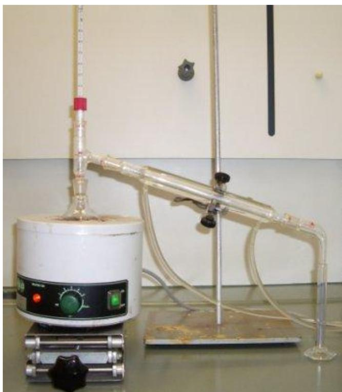
**Figura 3.4:** Sistema para a destilação manual utilizado para determinação da composição das frações destiladas.
