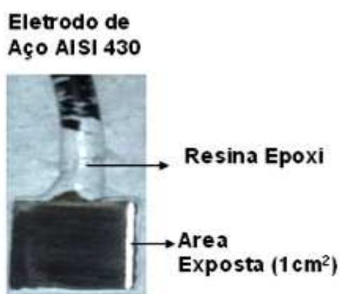
FIGURA 2. 4- Fotografia do eletrodo de trabalho de aço AISI 430 preparado para a eletrodeposição de cobalto.
