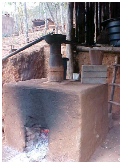
Figura 2.5 – Alambique de capelo simples.
