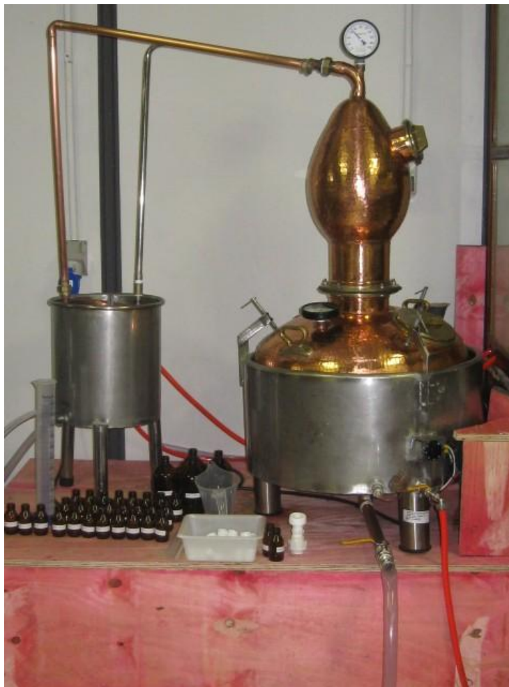
Figura 4.1 – Alambique termostatzado de cobre com condensador de aço inoxidável.
