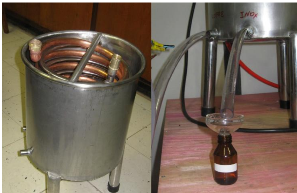
Figura 3.6 – Condensador com as serpentinas em cobre e aço inox.
