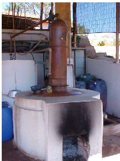
Figura 2.4 – Um alambique modelo serpentina simples com aquecimento direto.
