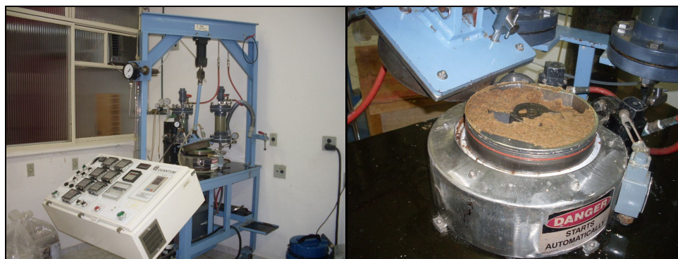
Figura 1.2 – Reator/misturador Quantum – Mark V para reações pressurizadas.
