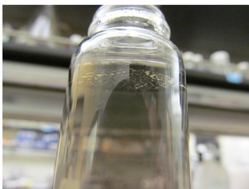
Figura 3.1: Fotografia de um filme de *carbon black* formado na interface água-ar pela sonicação de uma dispersão aquosa de CB. Originalmente o filme era contínuo e recobria toda a superfície. As rachaduras vistas na foto ocorreram após manipulação do recipiente.
