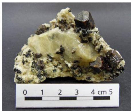
**Figura 1.1.** Foto do mineral pirocloro  $(\text{Na,Ca})_2\text{Nb}_2\text{O}_6(\text{OH,F})$  [37].
