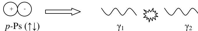
FIGURA 2: Aniquilação do p -Ps em repouso com a consequente emissão de dois fótons gama ( \gamma ) de 0,511 MeV de energia
