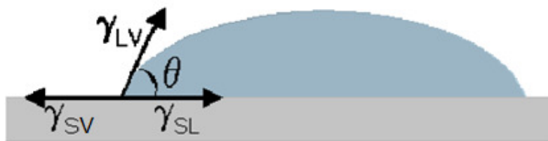
Figura 13 – Esquema de uma gota colocada na superfície de um sólido formando um ângulo de contato \theta com a superfície. \gamma_{LV} é a energia ou tensão superficial do líquido em equilíbrio com o vapor; \gamma_{SL} é a energia interfacial entre o líquido e o sólido e \gamma_{SV} é a energia de superfície do sólido em equilíbrio com o vapor.
