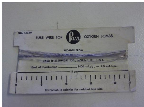
Figura 13. Fio metálico utilizado para ignição no experimento do poder calorífico
