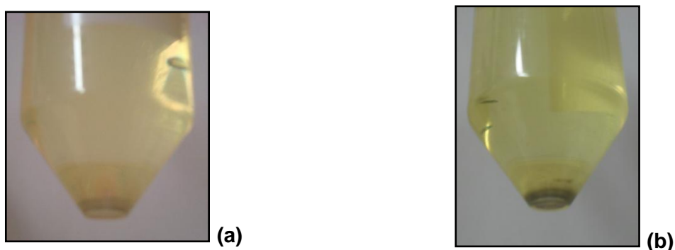
Figura 14. Resíduos remanescentes da amostra de lodo de esgoto de Belo Horizonte após aplicação do procedimento com \text{HNO}_3 e HF (a) e do procedimento com água régia invertida e HF (b), ambos com o programa de aquecimento I.
