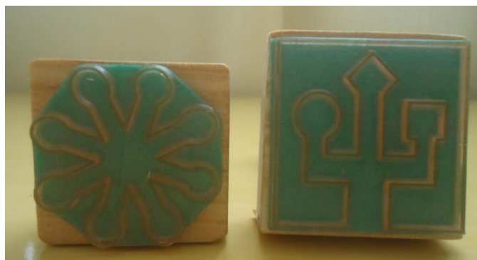
Figura 3.2. Carimbos utilizados para fabricação de \mu PADs pelo método proposto.
