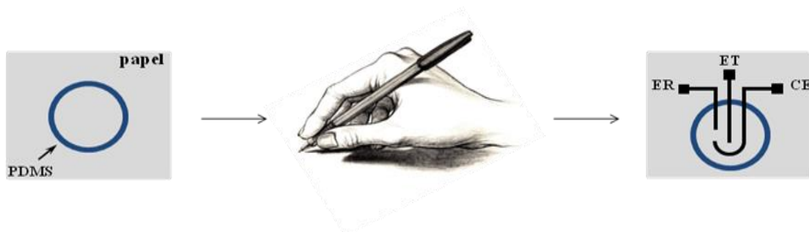
Figura 3.5. Desenho esquemático da obtenção do \mu PAD com detecção eletroquímica utilizado nos estudos de voltametria cíclica. Eletrodos de grafite feitos a mão utilizando lápis. ER, ET e CE são os eletrodos de referência, trabalho e contra-eletrodo, respectivamente.
