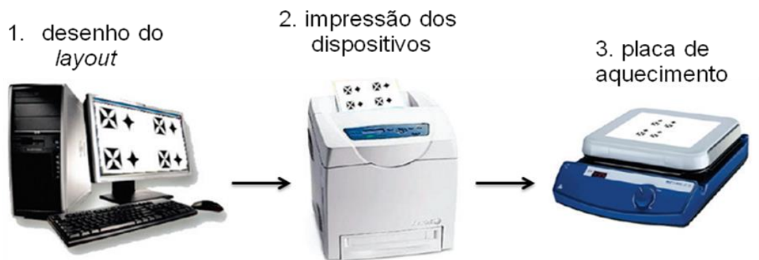
Figura 1.6. Representação esquemática das etapas necessárias para a fabricação de \mu PADs por impressão a cera (Adaptado de CARRILHO et al. , 2009).
