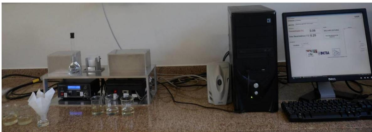
**Figura 18** Polarímetro utilizado na determinação da leitura sacarimétrica
