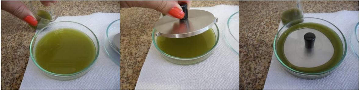
**Figura 16** Acessório de transfectância utilizado nas medidas dos espectros do caldo
