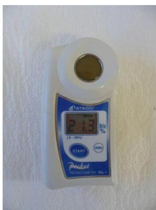
**Figura 20** Refratômetro digital para a determinação de brix
